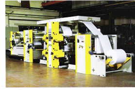
RS 25 avec impriméuse flexo - with in line flexo press - mit Flexodruckwerk
